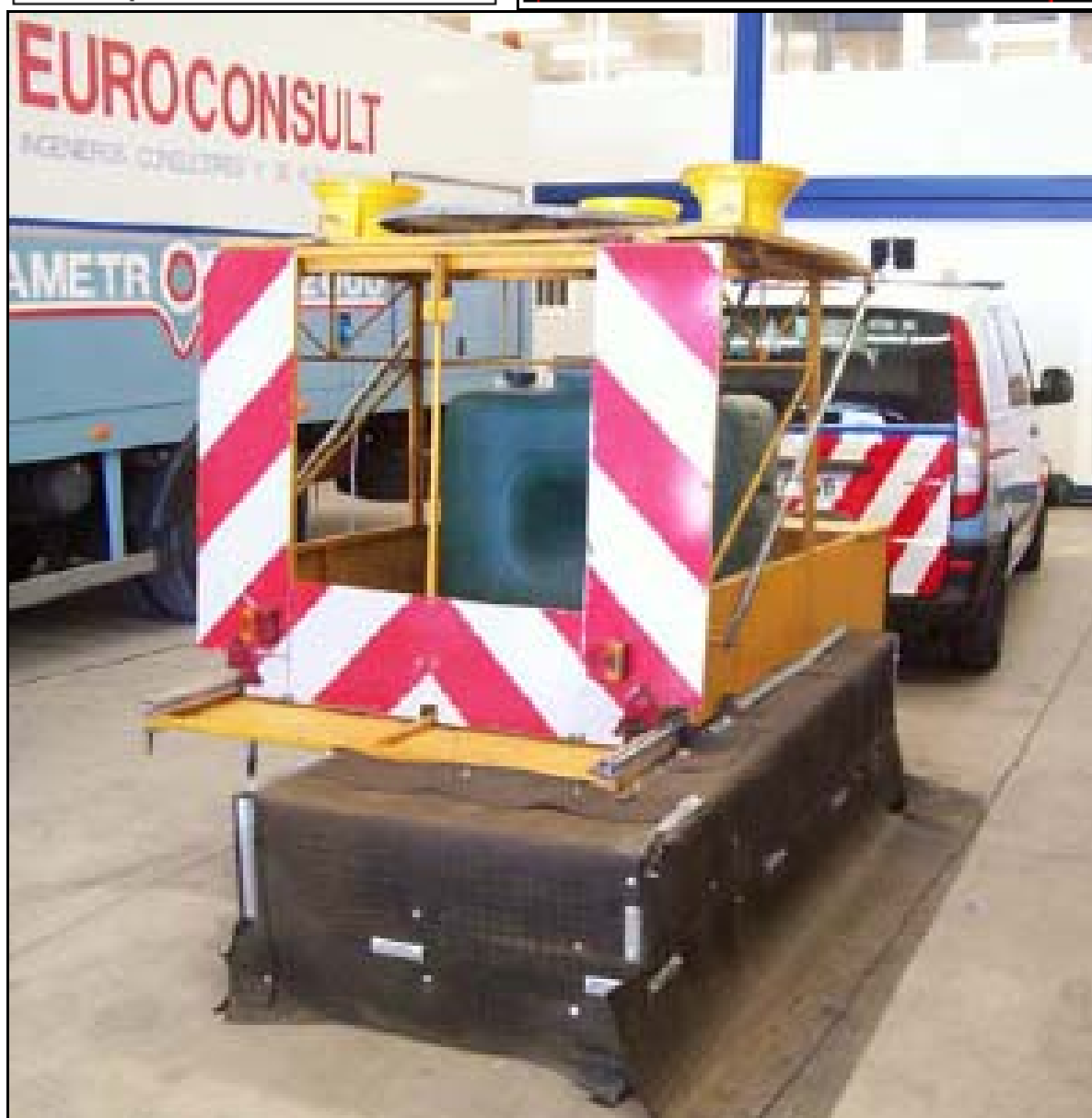
Prototyp zařízení na měření vodní clony (Španělsko)
