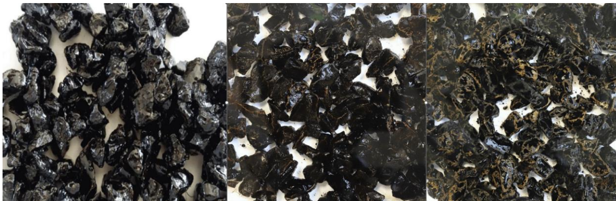
Obrázek 5 Výsledky zkoušky přilnavosti (vliv vody na přilnavost), vlevo - 100 %, uprostřed – 90 %, vpravo 75 % [27]
