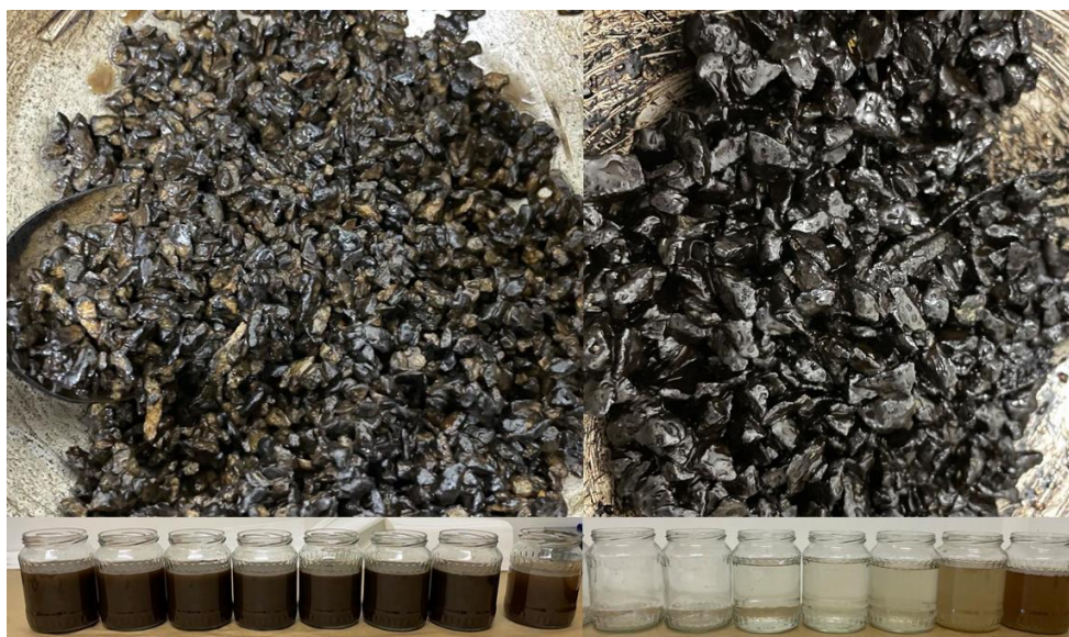
Obrázek 1 Výsledky zkoušek okamžité přilnavosti dle prEN 16346, 10 min zrání [28]
