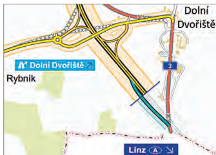
Obr. 2: D3 0312/II Provizorní komunikace na konci dálnice (modrozelená) převádějící dopravu na hranici mimo Dvořiště až do výstavby rakouské S10 (leták ŘSD 04/2026)
